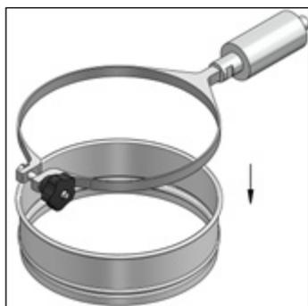
Spannung und Konverter vor dem Einsatz des anzuregenden Analysensiebes
